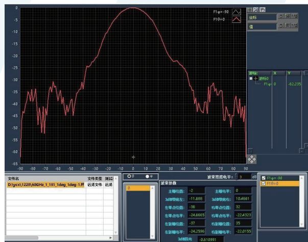
片上天线实测曲线 (60GHz)
