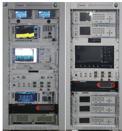
星载发射机测试验证系统实物照片
